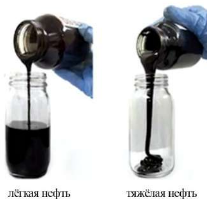
Рис. 1. Различия в вязкости между легкой и тяжелой нефтью
