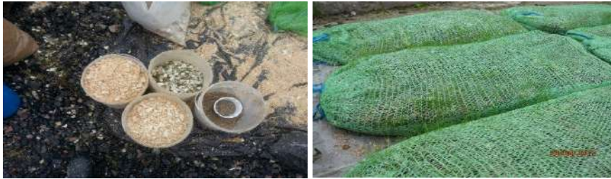
Рис. 21. Основные компоненты, входящие в состав фитоматов (фото Л. Ивановой): а — опилки, крупно фракционированный термовермикулит, семена; б — готовые фитоматы
