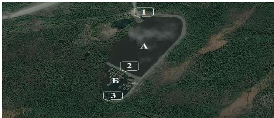
Рис. 7. Общий вид отстойника Кировогорского карьера: 1 — место сброса сточных вод в отстойник; 2 — дамба; 3 — место сброса сточных вод в природный водоток; А — первая секция отстойника; Б — вторая секция отстойника
